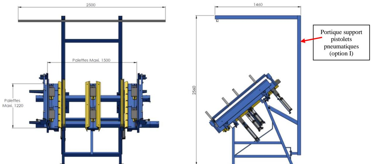
L'opérateur dépose dans le gabarit les neuf « dés », les trois traverses et les 5 à 7 planches, et une fois le serrage pneumatique des « dés » il effectue le clouage de ces trois éléments entre eux. Une fois la palette éjectée pneumatiquement, l'opérateur retourne la palette pour mettre les trois planches du dessous manuellement, c'est l'opérateur qui met en référence les planches de semelles par rapport au « dés » manuellement avant le clouage.
